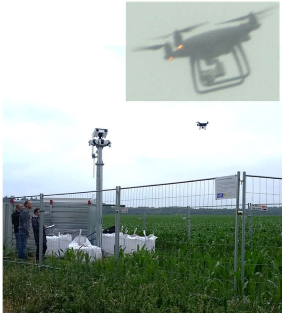
Abbildung 26: Erfassungstest mit GPS-verorteter Drohne. Das kleine Bild zeigt eine Aufnahme der Drohne durch das IDF aus einer Entfernung von ca. 150 m.
